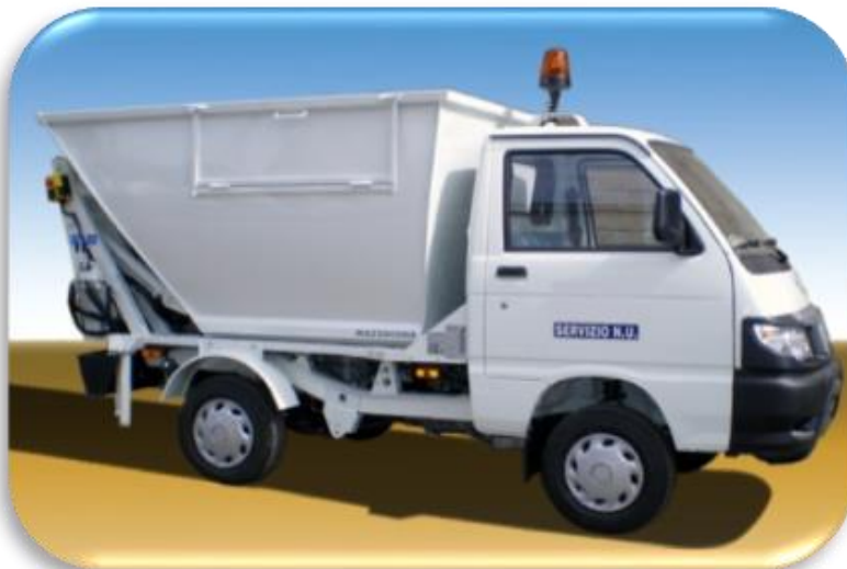
MOTOCARRO A VASCA, 2,5 MC DI CAPACITÀ
