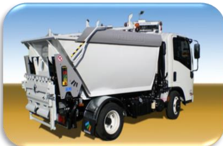
COSTIPATORE A VASCA, 7 MC DI CAPACITÀ.
