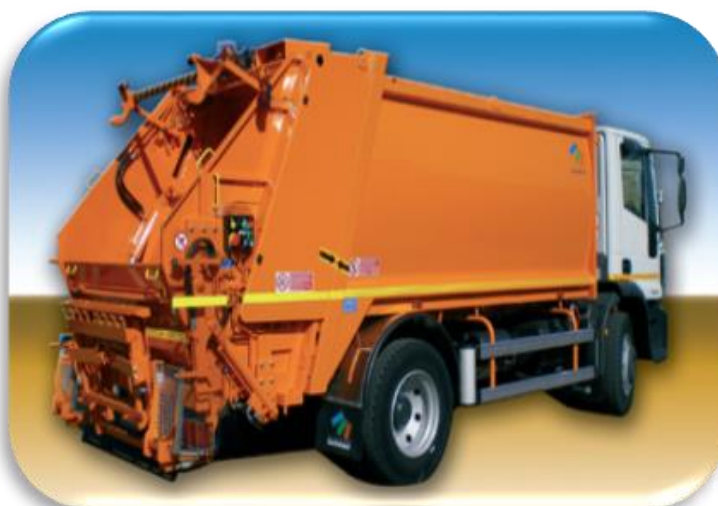
AUTOCOMPATTATORE, 18 MC DI CAPACITÀ
